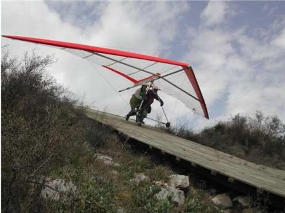
Toute accélération brutale est à proscrire, une mise en mouvement violente impliquera quasi systématiquement une rupture d'incidence engendrée par l'inertie due au poids de l'aile. De plus l'écoulement des filets d'air sera plus perturbé et la traînée parasite sera d'autant plus importante..
